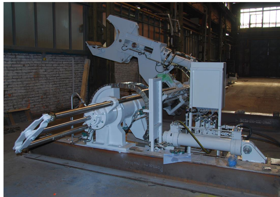
Manipulátor pro odkládání zbytkových svitků drátu
