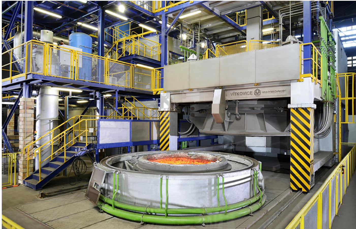
Zařízení sekundární metalurgie VD/VOD-VIT, kapacita 45 tun
