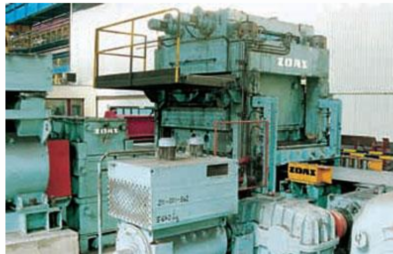
Válcová rovnačka tlustých plechů
