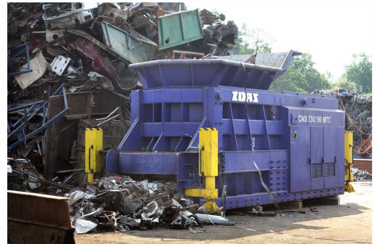
Hydraulické nůžky na šrot CNS 730 M
