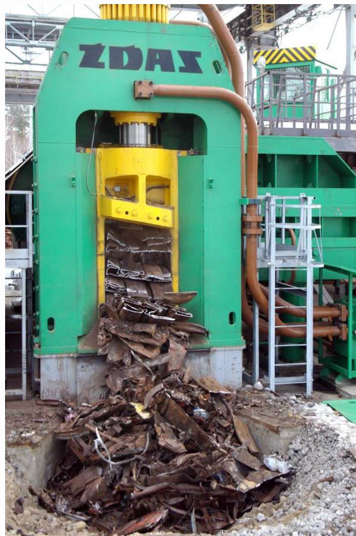
Hydraulické nůžky na šrot CNS 1100 - CV2
