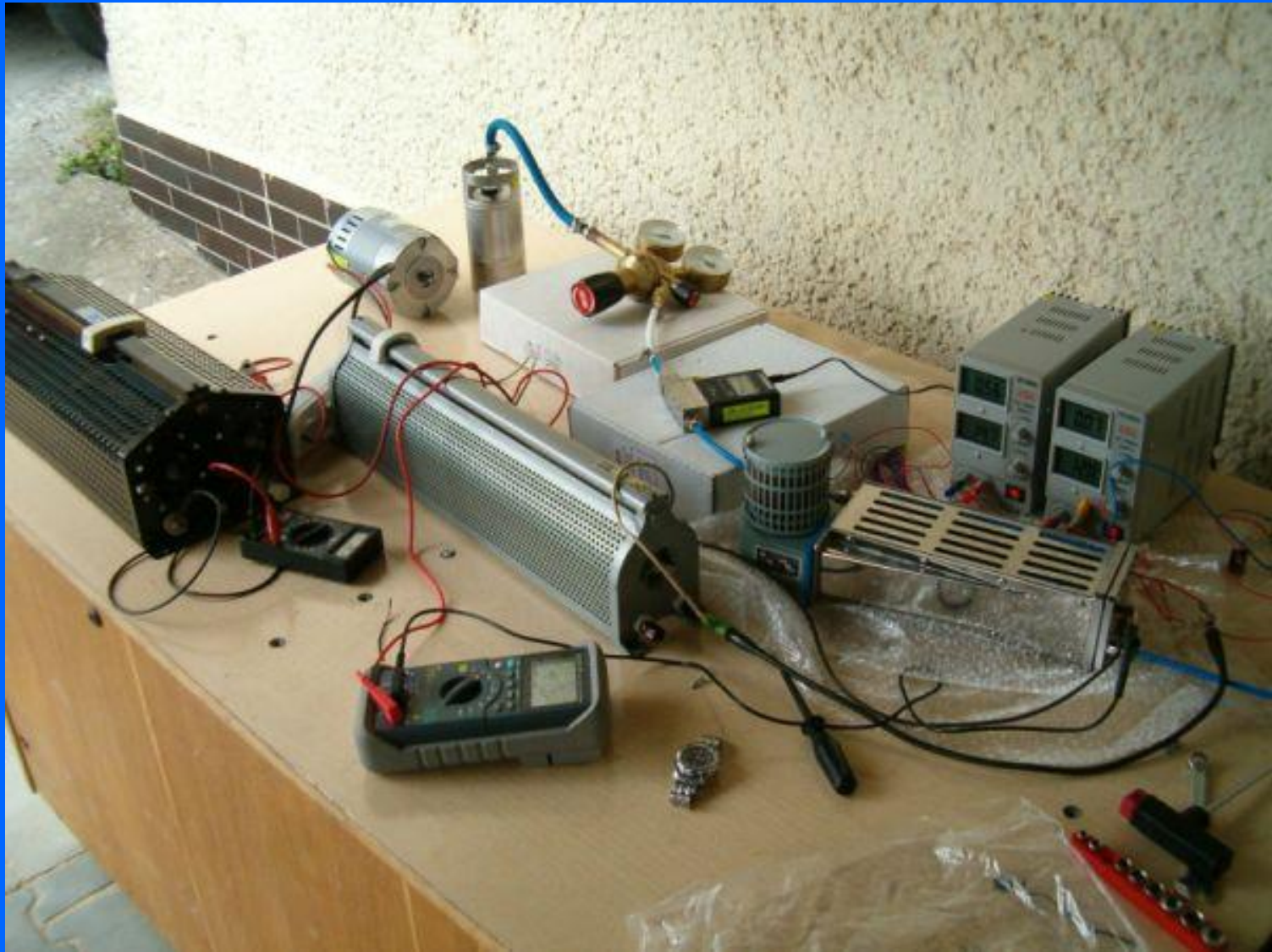
Soustava pro měření charakteristiky PEM palivového článku a ověření vlastností pohonu vozidla HydrogenIX
