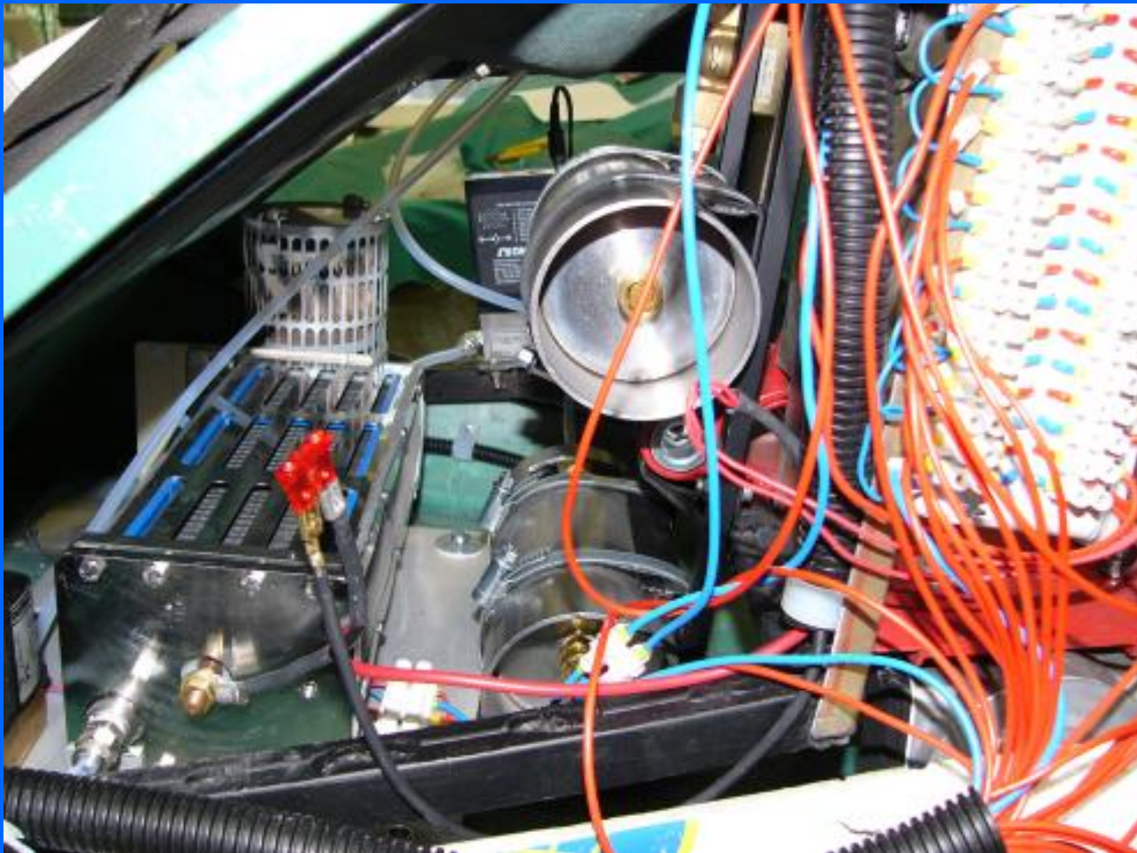
Zástavba palivového článku FYD a zásobníhů vodíku v zadní části vozidla HydrogenIX.
