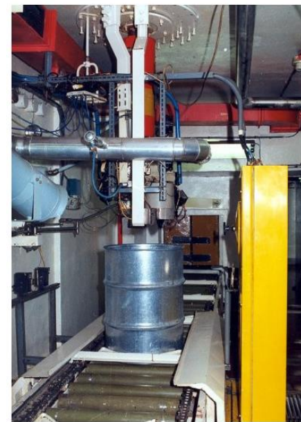
Reaktorový sál A1, bitumenační linka na zpracování RAO
