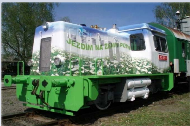
Přestavěná diesellová lokomotiva 714 na pohon CNG
