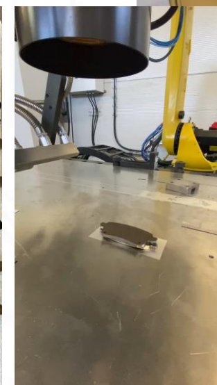
Zdrsňování a čištění – náhrada mechanického procesu. 6000 ks / směna
