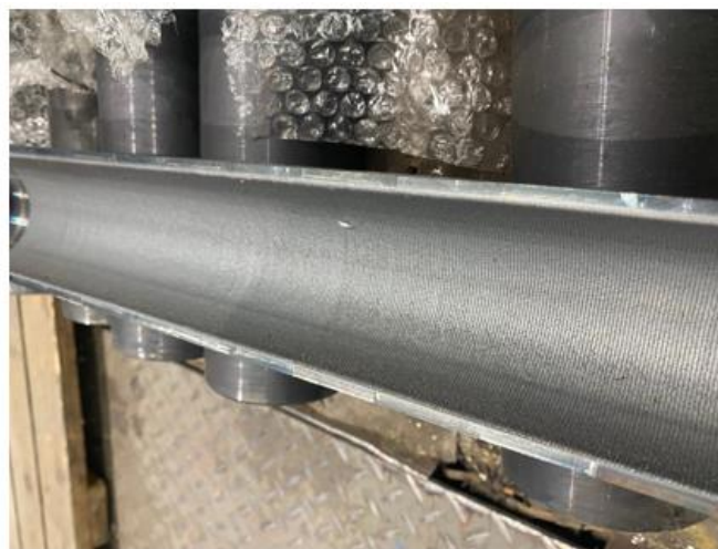
Obrázek 5 - Povrch navařeného vnitřního průměru (Řez trubky)
