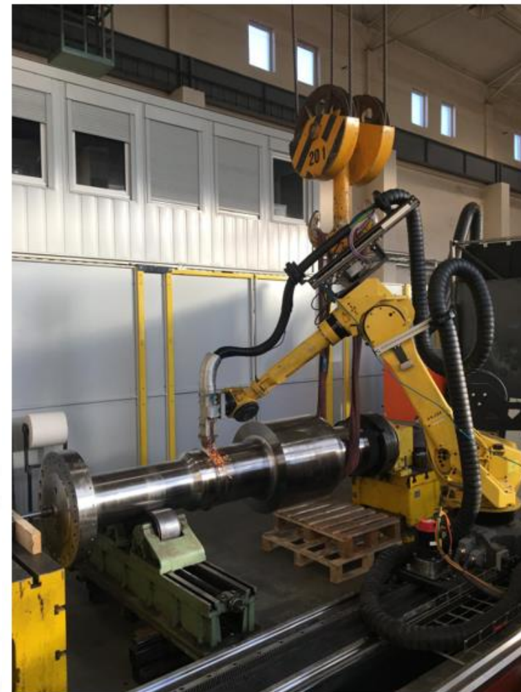
Obrázek 10 - Oprava funkční části na průměru hřídele (Přídavný mat. 316 L)
